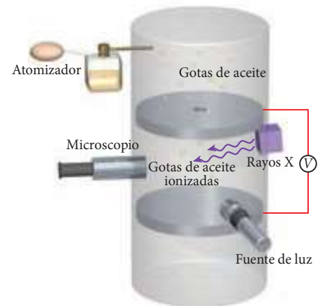
FIGURA 21.4 Esquema del experimento de Millikan de la gota de aceite.
