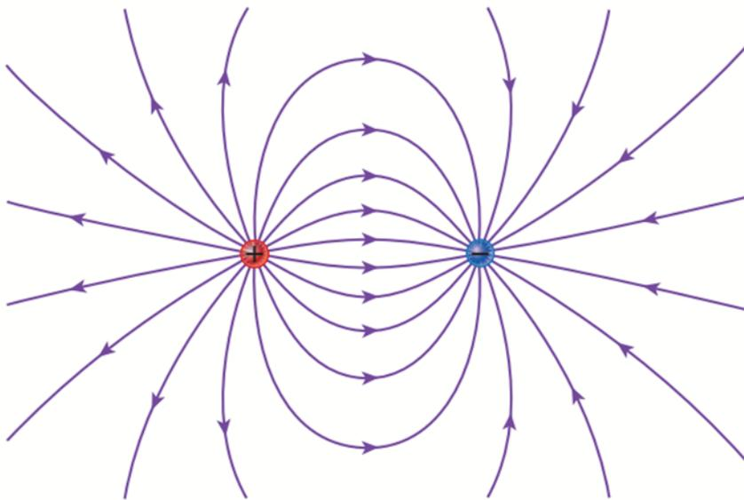
**FIGURA 22.7** Líneas de campo eléctrico creado por dos cargas puntuales con cargas opuestas. Cada carga tiene la misma magnitud.
