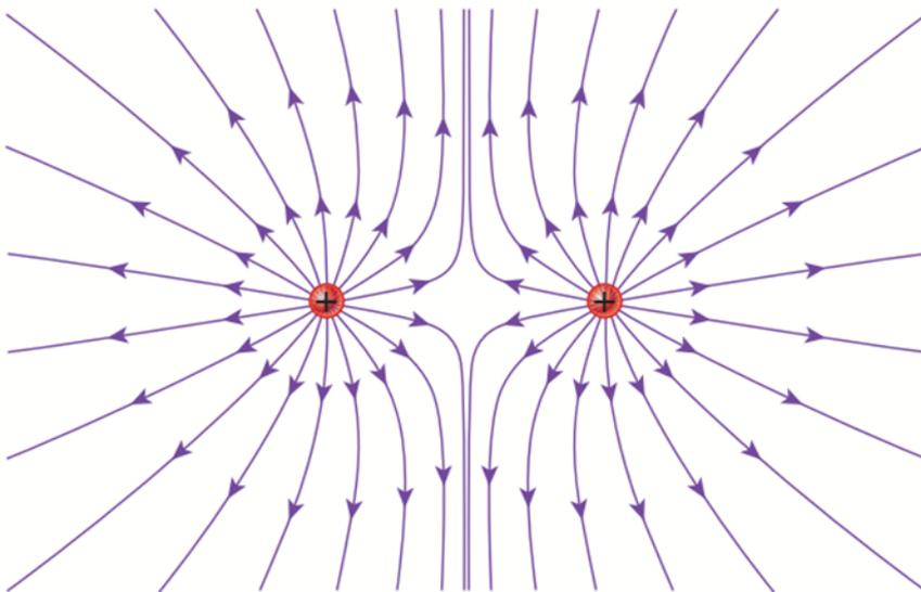
**FIGURA 22.8** Líneas de campo eléctrico creado por dos cargas puntuales positivas con la misma magnitud.
