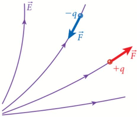
**FIGURA 22.4** Campo eléctrico no uniforme. Una carga positiva  $+q$  y una carga negativa  $-q$  colocadas en el campo experimentan fuerzas, como se muestra. Cada fuerza es tangente a la línea de campo eléctrico.
