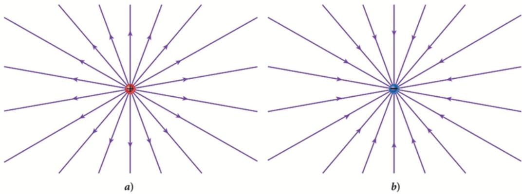
**FIGURA 22.6** Líneas de campo eléctrico a) desde una carga puntual positiva y b) hacia una sola carga puntual negativa.
